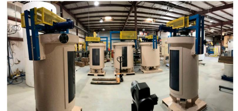
Lieferung der Eindickertanks für die Pilotanlage
