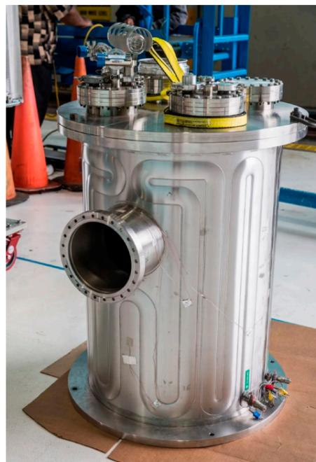
Das zusammengebaute Kilopower-Experiment, eingeschlossen in einer Vakuumkammer im Glenn Research Center der NASA.
